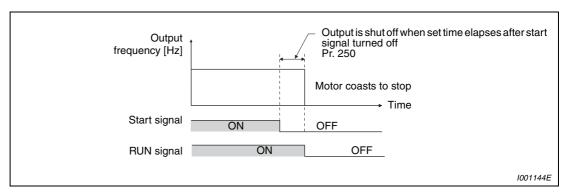
Fig. 6-42: Stop operation when parameter 250 ≠ 8888 or 9999
