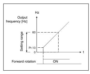
Fig. 6-28: Starting frequency parameter
