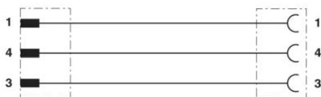
Kontaktbelegung der M8-Stecker/Buchse
