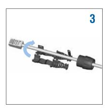
Install the cable clamp-boot.
