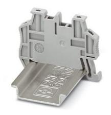
Appoggio terminale a montaggio rapido, per guida NS 35/7,5 oppure per guida NS 35/15, siglabile con nastro Zack ZB 5 e ZBF 5, portacartellini per morsettiere KLM 2 e KLM, possibilità di posizionamento per FBS...5, FBS...6, KSS 5, KSS 6, spessore: 5,15 mm, colore: grigio
