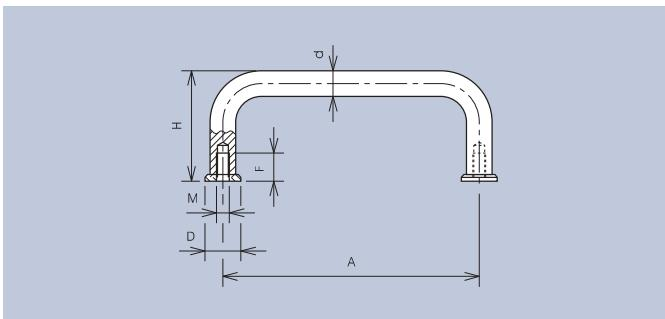
Einschließlich Abschlusscheiben, Zylinderschrauben-M3 x 8 / M4 x 12 / M5 x 12 und Scheiben.
