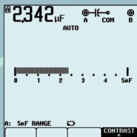
Controllo del condensatore di avviamento di un motore utilizzando lo ScopeMeter della Serie 120.
