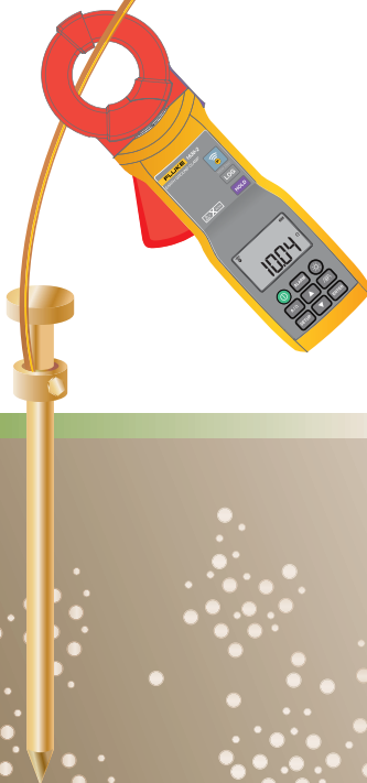
Predisposizione per il test senza picchetti utilizzando 1630-2 FC.
