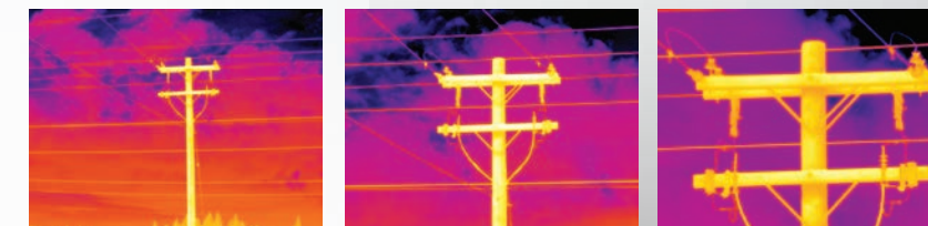
Standard (til venstre), 2x tele (midten) og 4x tele (til højre)-se de kritiske infrarøde detaljer på korrekt niveau
