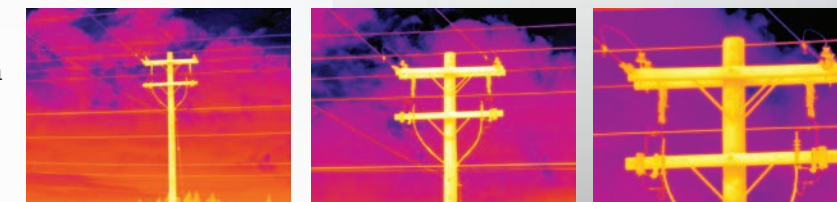
Standard (sinistra), teleobiettivo 2x (centro) e teleobiettivo 4x (destra)—il corretto livello di dettaglio all'infrarosso
