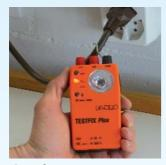
Contrôle de tension sans contact
