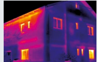
Scoprire le perdite di energia negli edifici: individuare e rappresentare immediatamente i ponti termici in una facciata o in un edificio.
