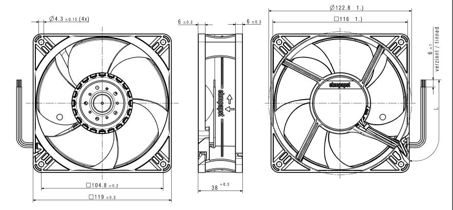
Zeichnung entspricht 3D-Modell: Drawing is equivalent to 3D-Model: 9293510500\_CPA\_000\_A
