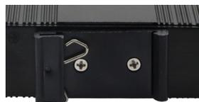
Zur Montage der Wandhalterung wird das DIN-Rail-Kit durch den Montagebügel ersetzt
