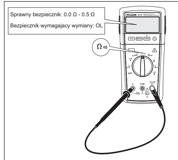
Rysunek 11. Sprawdzanie bezpiecznika
