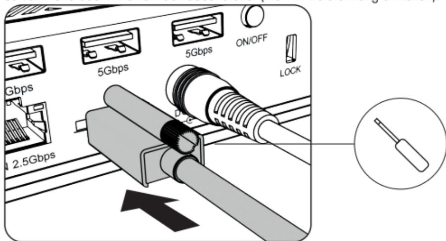
3. Verbinden Sie nun das andere Ende des mitgelieferten Datenkabels über den USB Type-C® Stecker oder über den Type-A Adapter mit einem unterstützten Computer (mindestens USB 3.2 Gen 1).
