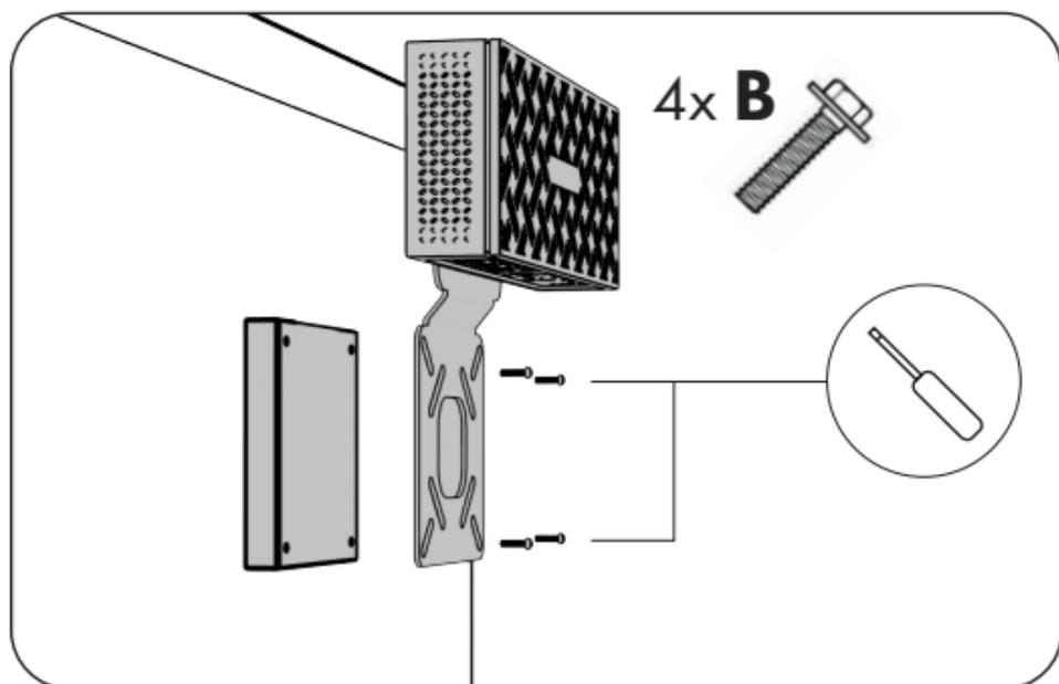
c. Wenn Sie einen Monitorarm verwenden, positionieren Sie das Gerät wie unten gezeigt zwischen der VESA-Halterung des Monitors und der VESA-Halterung des Monitorarms und befestigen Sie es mit den vier mitgelieferten M4x12 mm-Schrauben.
