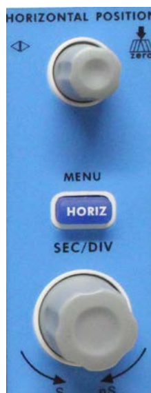
Abb. 12 Bedienelemente für Horizontalsteuerung
