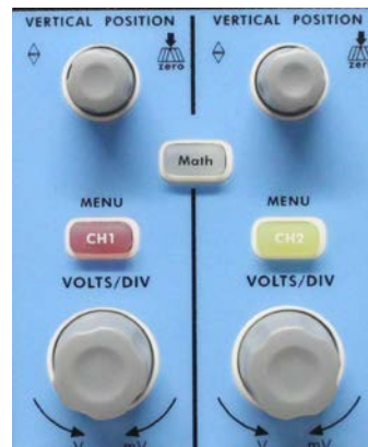
Abb. 11 Bedienelemente für Vertikalsteuerung
