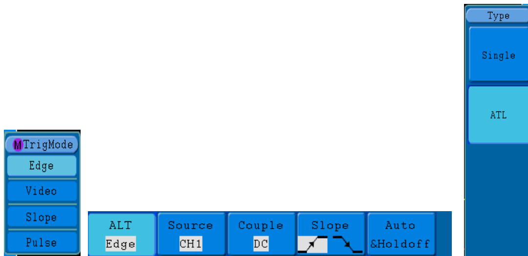
Abb.34 Menü für alternierenden Trigger (ALT) (Triggertyp: Edge)
