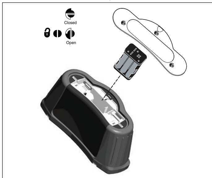
Figure 24. Remplacement des piles
