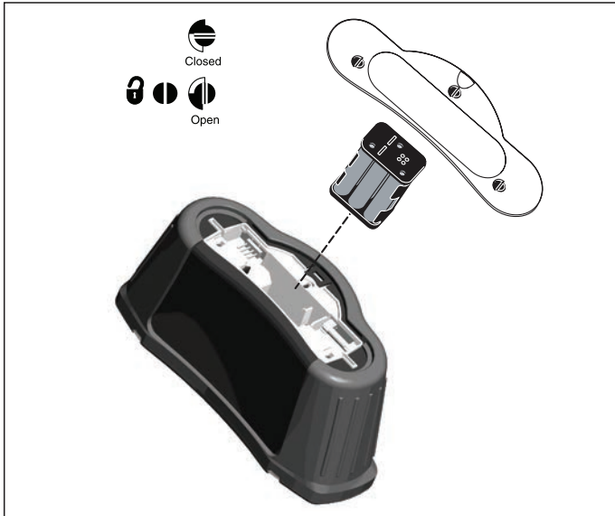
Figura 24. Sostituzione delle batterie
