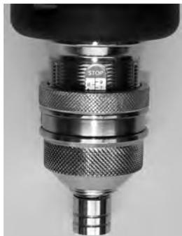
Zur Sicherung des eingestellten Drehmomentwerts können Sie den Feststerring verwenden bzw. durch Entfernung des Stahlrings können Sie eine Einstellschraube\* befestigen, wobei Sie auf die entsprechenden Rillen achten müssen.
