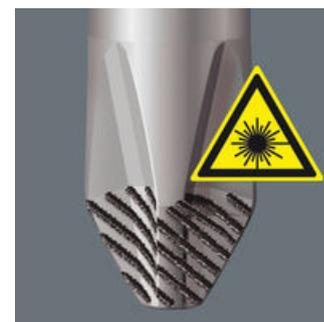
Tramite un raggio laser concentrato, si crea una superficie di strutturazione a spigolo vivo. Il trattamento al laser accresce la durezza delle scanalature fino a 1000 HV 0,3. La lama Lasertip della Wera si aggrappa saldamente nella testa della vite evitando che ne slitti fuori. Adatto per viti a taglio, Phillips e Pozidriv.
