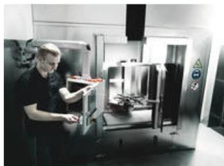
Il collaudo di ogni singolo pezzo a 10.000 Volt secondo IEC 60900 garantisce un lavoro sicuro sotto tensione fino a 1.000 Volt.
