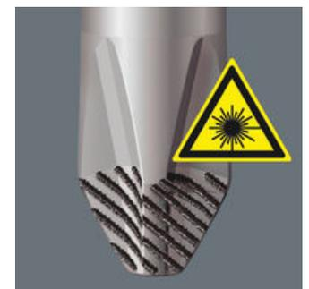
Tramite un raggio laser concentrato, si crea una superficie di strutturazione a spigolo vivo. Il trattamento al laser accresce la durezza delle scanalature fino a 1000 HV 0,3. La lama Lasertip della Wera si aggrappa saldamente nella testa della vite evitando che ne slitti fuori. Adatto per viti a taglio, Phillips e Pozidriv.
