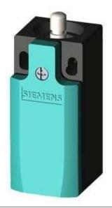
SIRIUS POSITION SWITCH PLASTIC HOUSING ACC. TO EN50047, 31MM DEVICE CONNECTION 1X (M20X1.5); 1NO/1NC SLOW-ACTION CONTACTS TEFLON PLUNGER
