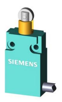
COMPACT SWITCH 30MM WIDE W. CONNECTING CABLE 2M SNAP-ACTION CONTACTS 1NO+1NC ROLLER PLUNGER
