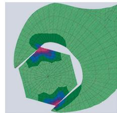
Zangenschlüssel: spielfreie Flächenpressung, keine Kantenbeschädigung
