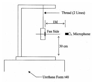
1 METER FROM MICROPHONE TO FAN INTAKE
