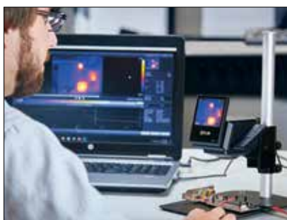
Připojení USB kabelem k počítači pro analyzování dat v softwaru FLIR Tools+
