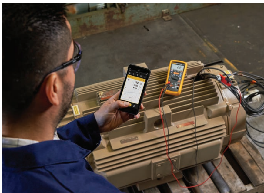
Memorizzazione e condivisione dati utilizzando Fluke 1587 FC con la app per misure Fluke Connect.
