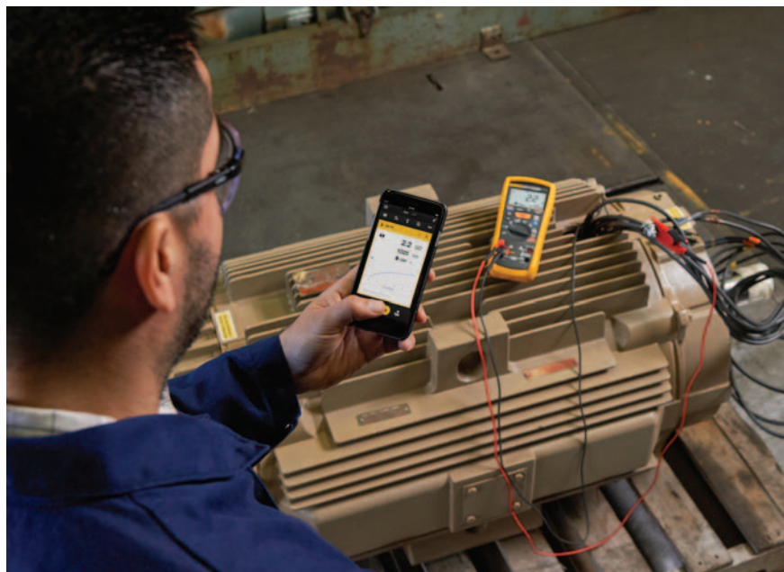
Gem og del data med Fluke 1587 FC med Fluke Connect mobil app.
