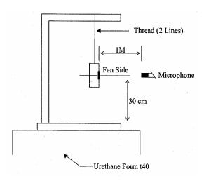
1 METER FROM MICROPHONE TO FAN INTAKE
