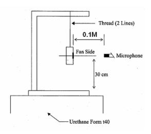
0.1 METER FROM MICROPHONE TO FAN INTAKE
