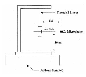
1 METER FROM MICROPHONE TO FAN INTAKE
