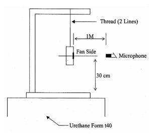
1 METER FROM MICROPHONE TO FAN INTAKE
