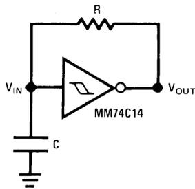
$$t_1 \approx RC \ln \frac{V_{T+}}{V_{T-}}$$
