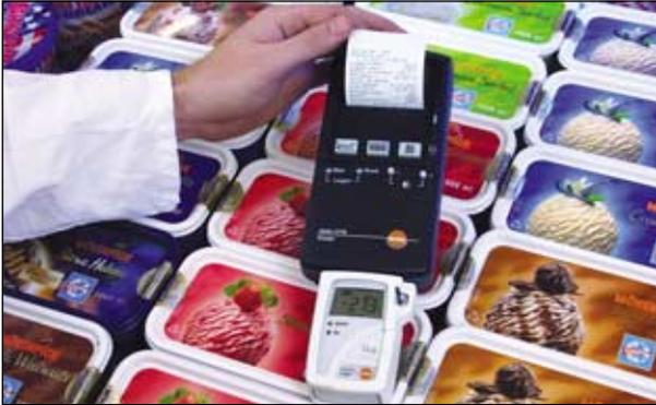
Daten vor Ort mit hoher Geschwindigkeit ausdrucken, das war eine Anwenderforderung, die Testo konsequent umgesetzt hat. Mit dem Schnelldrucker testo 575, der sogar den Logger neu starten kann, ohne einen PC anschließen zu müssen.
