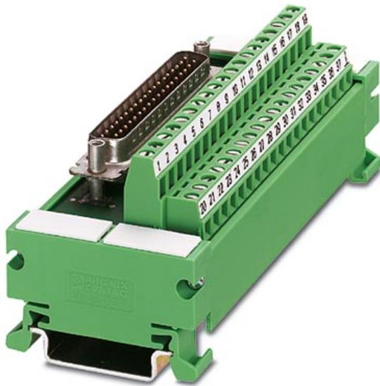
VARIOFACE-Modul, mit Schraubanschluss und D-Subminiatur-Stiftleiste, zur Montage auf NS 35/7.5, Polzahl 25
