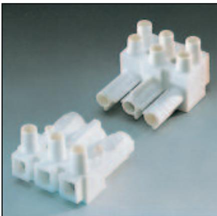
Alle Pole werden gleichzeitig gesteckt. Schutzleiter voreilend. Die spannungsführenden Teile sind im gesteckten und ungesteckten Zustand auch gegen zufälliges Berühren geschützt.
