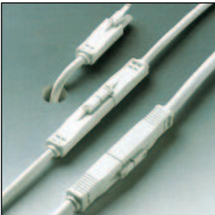
Die Klemmenstellen bei Steckern und Buchsen der „Snap-in“-Ausführung sind schraubenlos. Die Materialstärke des Trägers kann 0,5 – 1,5 mm betragen; die Ausschnittmaße sind mit **16,7 x 23 mm** (2polig) bzw. **23 x 23 mm** (3- und 4polig) festgelegt.
