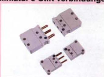
3-Stift Verbindungen für den Einsatz bis 175°C. Für die Thermoelement Typen J, K, T und R/S sowie Kupfer erhältlich. Auf den farbcodierten Körpern, aus glasgefülltem Nylon, sind die Pole markiert.
