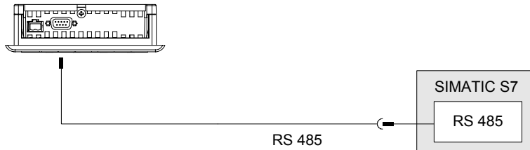
Bild 4-15 Steuerung an ein OP 77A anschließen
