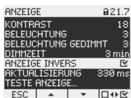
Bild 9-15 Geräteeinstellung "ANZEIGE INVERS" eingeschaltet
