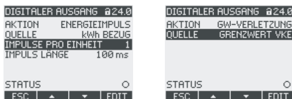
Bild 9-10 Geräteeinstellung "DIGITALER AUSGANG"
