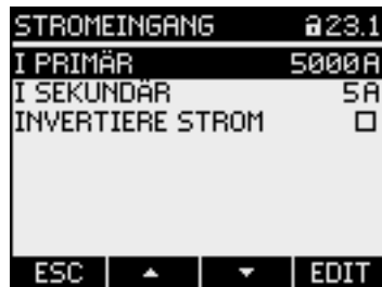
Bild 7-10 Geräteinstellung "STROMEINGANG - I PRIMÄR"
