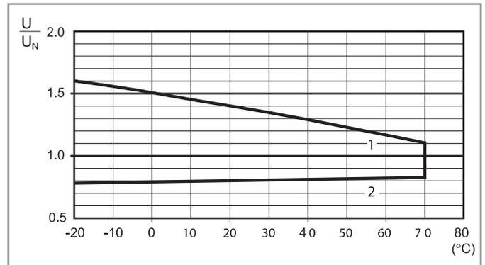
**R 62 - Campo di funzionamento bobina DC in funzione della temperatura ambiente - Tipo NO**
