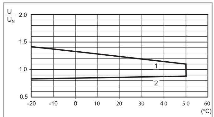
1 - Max tensione bobina ammissibile.
